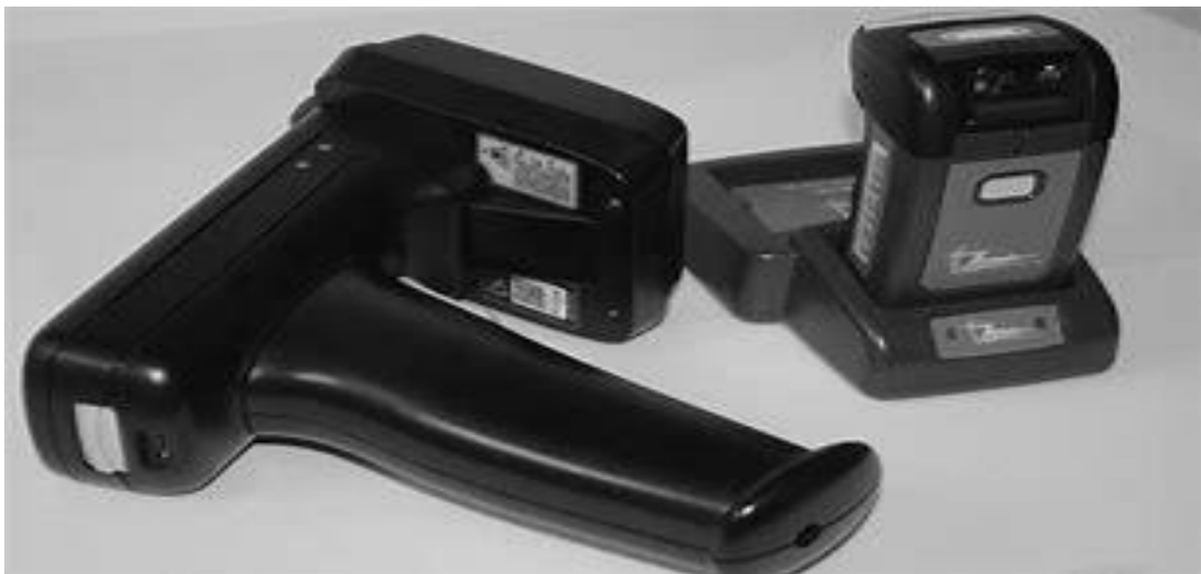
Gambar 5 Reader RFID seperti peralatan genggam
